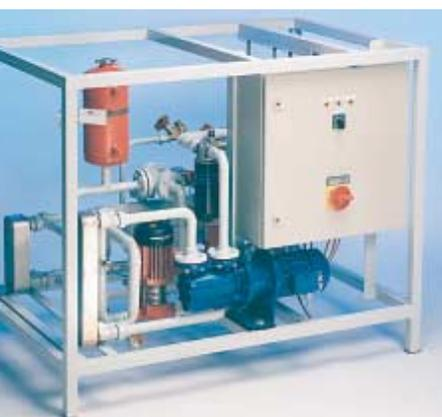
Серия TPL разработана специально для случаев применения в машино- и приборостроении (например, охлаждение гидравлических и моторных масел). Объем проточных каналов теплообменников данной серии до 80 % больше объема каналов аппаратов с классическими теплообменными пластинами. Благодаря специальным турбулентным пластинам, диагональному потоку сред и максимально широкому диаметру присоединений достигается огромная мощность теплопередачи.
