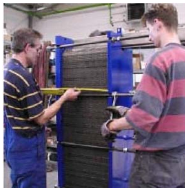
Рис 6.3: Правильный порядок вскрытия ПТО с контролем допустимого перекося нажимной плиты.
