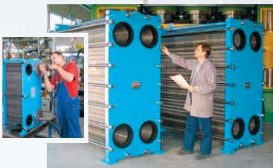
Гидравлическая опрессовка и конечный визуальный контроль являются завершающим этапом сборки теплообменников
