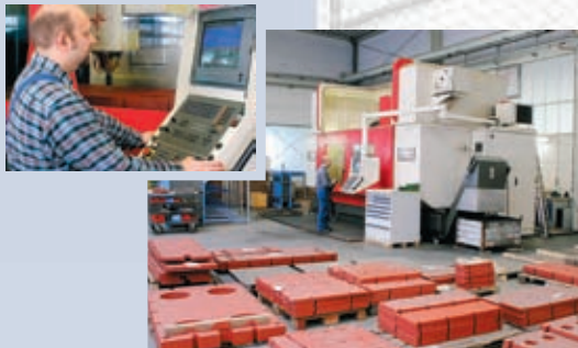
Установка CNC для производства корпусов ПТО
